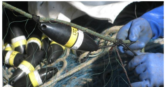
Abbildung 4: „PAL“v.1 an der Kopfleine eines Stellnetzes
